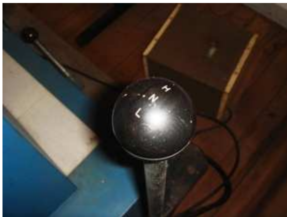
Figura 21 - Câmbio da Redução (High, Neutral Low)
