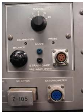
Figura 26 – Interface de entrada do Extensômetro
