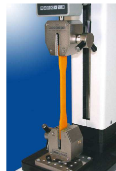
Figura 4 - Corpo de Prova Durante Ensaio
